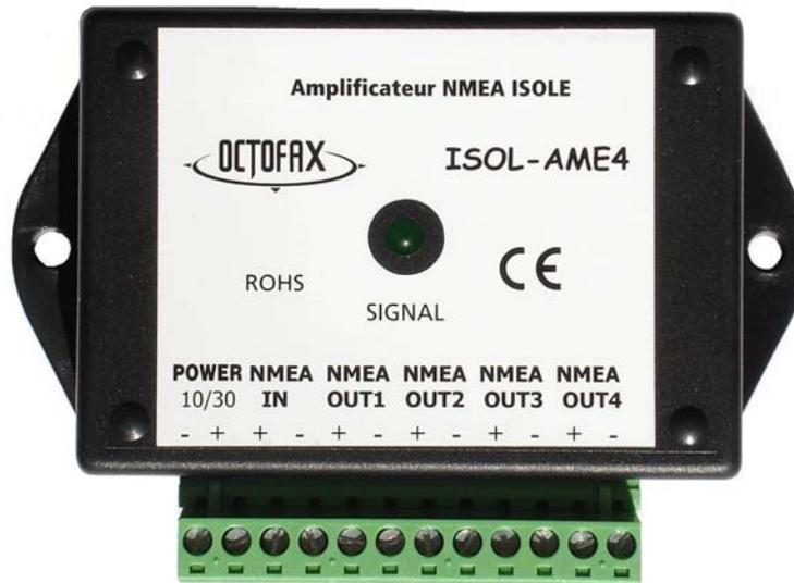
Cet appareil opto-isolé à l'entrée et à chaque sortie vous permet d'envoyer par exemple l'information NMEA du GPS vers plusieurs appareils (Centrale de navigation, Pilote automatique, VHF, AIS, Cartographie PC...) avec le maximum de sécurité. La diode LED visualise la présence du signal.
